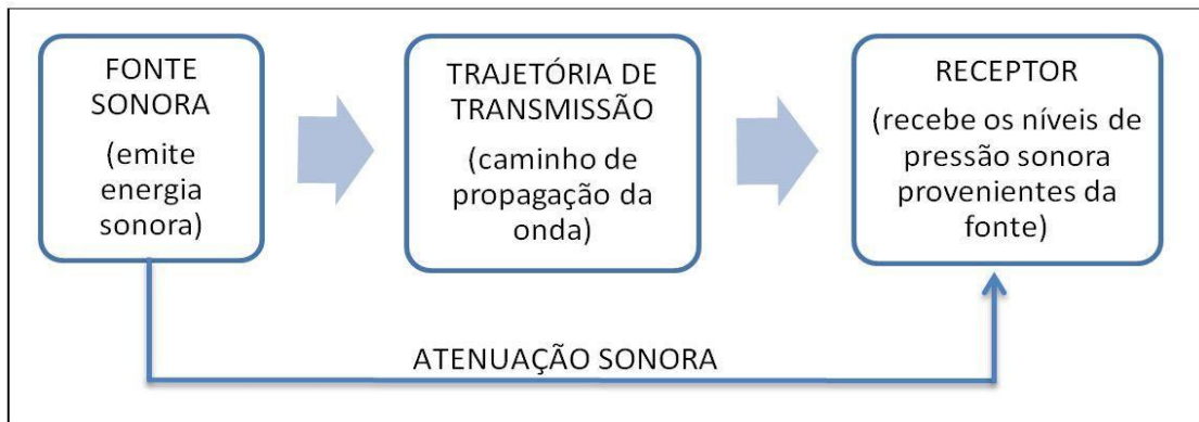
Figura 10 - Mecanismo de propagação da onda sonora ao ar livre.
